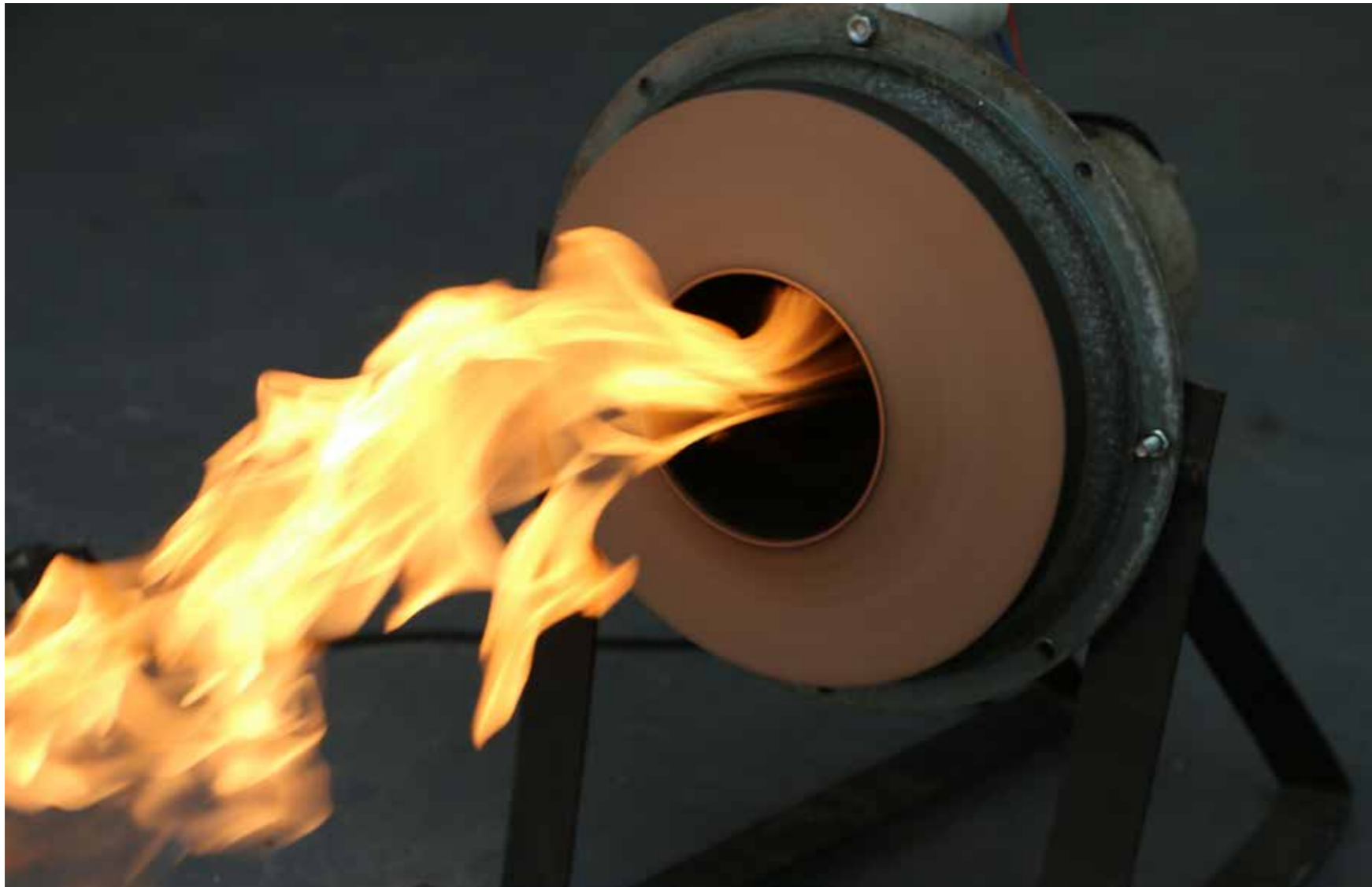
Propane, brûleur de chaudière, ventilateur, système électrique. Propan, oil burner, electric fan, electric system.
